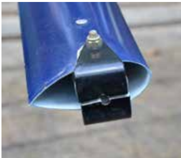
Figure 4. Support de fixation rompu du hauban de l'aile avant de droite
