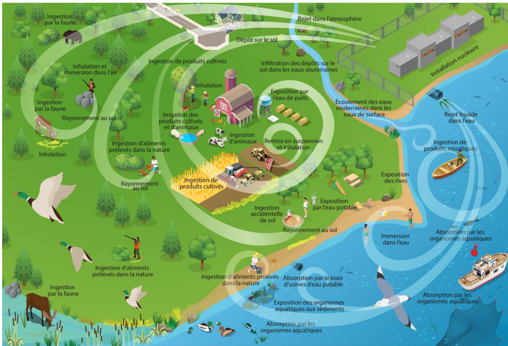
Figure 3.1 : Représentation graphique des voies d'exposition pour une installation générique de traitement de substances nucléaires
